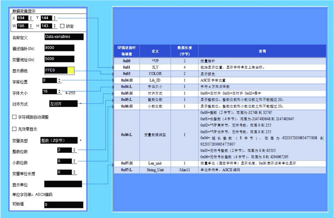
控件属性与指令存储格式对应图
